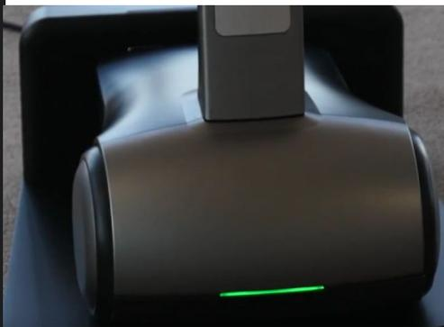
Placez le robot Beam+ sur la base de chargement : la lumière verte s'allume et vous indique qu'il est en charge.
