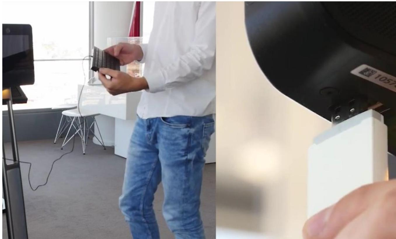
Connectez le robot Beam+ en sélectionnant un des réseaux Wifi détectés et affichés à l'écran ou en branchant une clé 4G préalablement configurée, toujours via le port USB. Débranchez ensuite le clavier.
