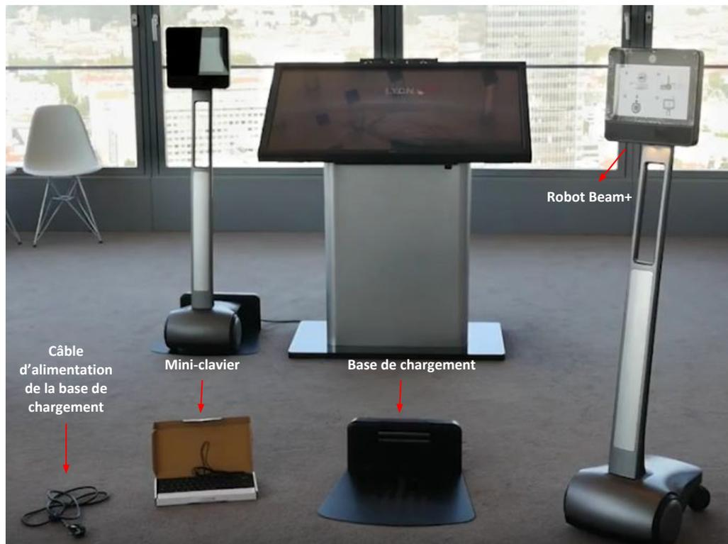
Sortez les éléments du carton un à un : le mini-clavier, le robot Beam+, le câble d'alimentation ainsi que la base de chargement.
